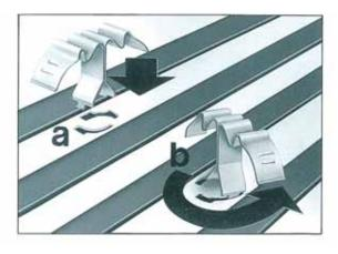
Profilo KF 55/3560 e KFE 55/3561: Inserire la clips e ruotarla fino al suo bloccaggio
