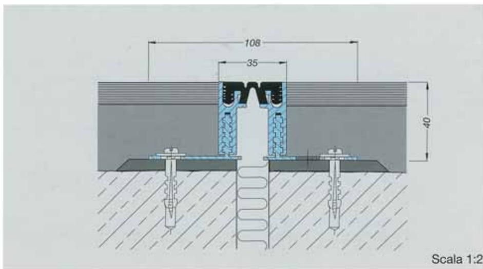
tendo sempre da una estremità del profilo. È consigliabile l'uso di un rullo per installare la guarnizione, facendo pressione su un lato per volta.
